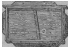
Доска-лекало для сколачивания рамок с заворотышем (о).
