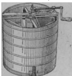
Рис. 2. Четырехрамочная медогонка с оборачивающимися от руки кассетами.
